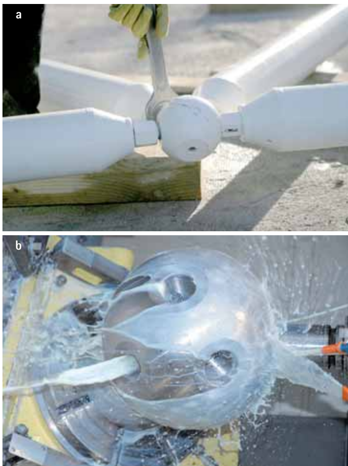
Fig. 17 - a) Nodo tipico tipo "MERO" e b) lavorazione del nodo con centro di lavoro a controllo numerico
