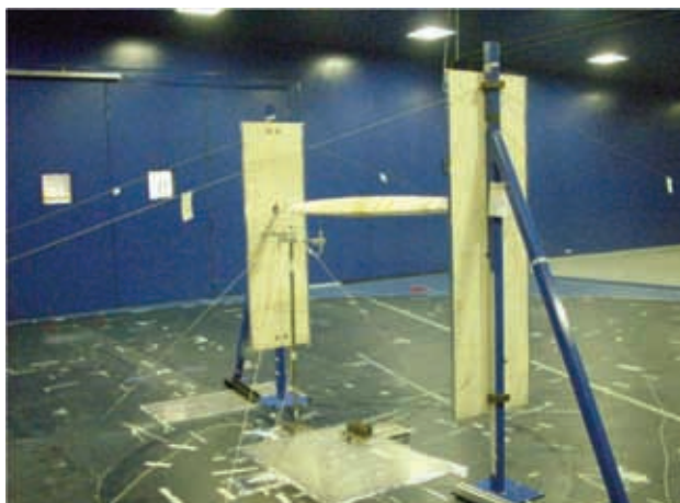
Figura 17 - Immagini del modello in scala del pilone in galleria del vento
