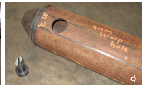
Fig. 30 - Differenti tipi di rottura delle aste testate: a) rottura del tubo, b) rottura della saldatura che collega il cono al tubo, c) rotture del bullone che collega l'asta tubolare al nodo sferico
