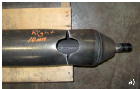
Fig. 30 - Differenti tipi di rottura delle aste testate: a) rottura del tubo, b) rottura della saldatura che collega il cono al tubo, c) rotture del bullone che collega l'asta tubolare al nodo sferico
