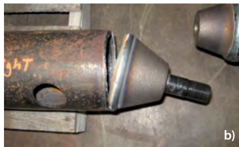
Fig. 30 - Differenti tipi di rottura delle aste testate: a) rottura del tubo, b) rottura della saldatura che collega il cono al tubo, c) rotture del bullone che collega l'asta tubolare al nodo sferico
