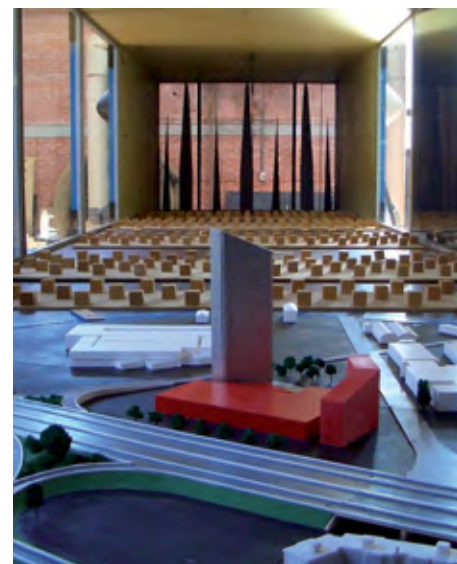
Fig. 10 - Vista laterale della reticolare e della torre Unipol e modello in galleria del vento
