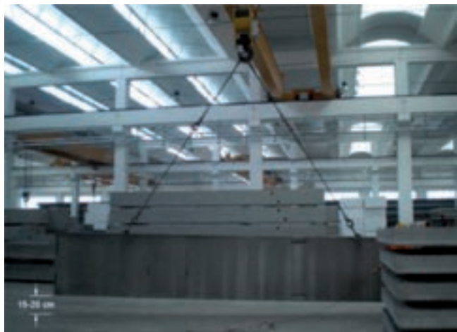
Figura 1 - Pannello appeso per mezzo di catene metalliche prima dell'inizio della sessione di misura
