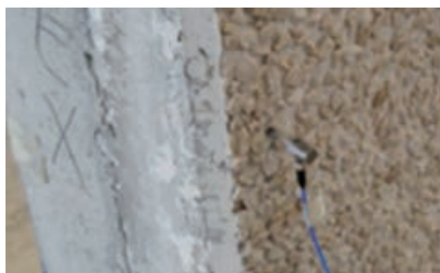
Figura 3: posizionamento dei due accelerometri
