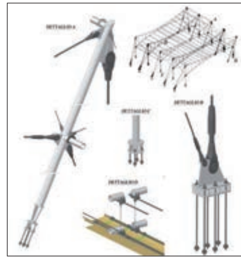
Figura 6: Assonometria e dettagli costruttivi della copertura del decumano
