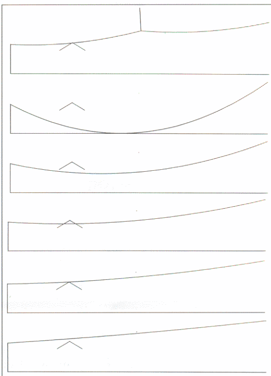
Soluzione A: Sforzo nella fune 50 kN Sforzo nel pendolo 17 kN Soluzione B Fase 1: Sforzo nella fune 25 kN Soluzione B Fase 2: Sforzo nella fune 50 kN Soluzione B Fase 3: Sforzo nella fune 100 kN Soluzione B Fase 4: Sforzo nella fune 200 kN Soluzione B Fase 5: Sforzo nella fune 1500 kN
