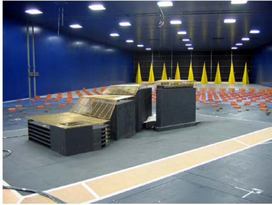
Figura 17: modello 1:50 e grafico tipico dei coefficienti di forza sulla copertura
