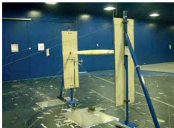
Fig. 30 - Immagini del modello in scala del pilone in galleria del vento
