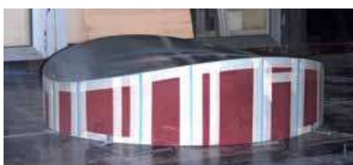
Fig.320 Immagine del modello in galleria del vento a maglia circolare
