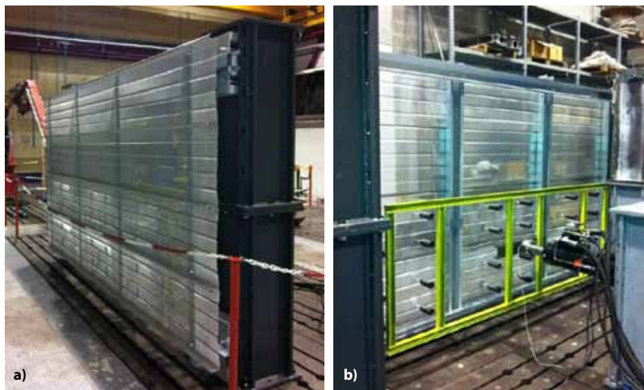
Fig. 24 - a) Vincolo a terra della copertura e delle travi di appoggio durante la prova a fatica, b) Modulo di copertura e sistema di distribuzione della forza
