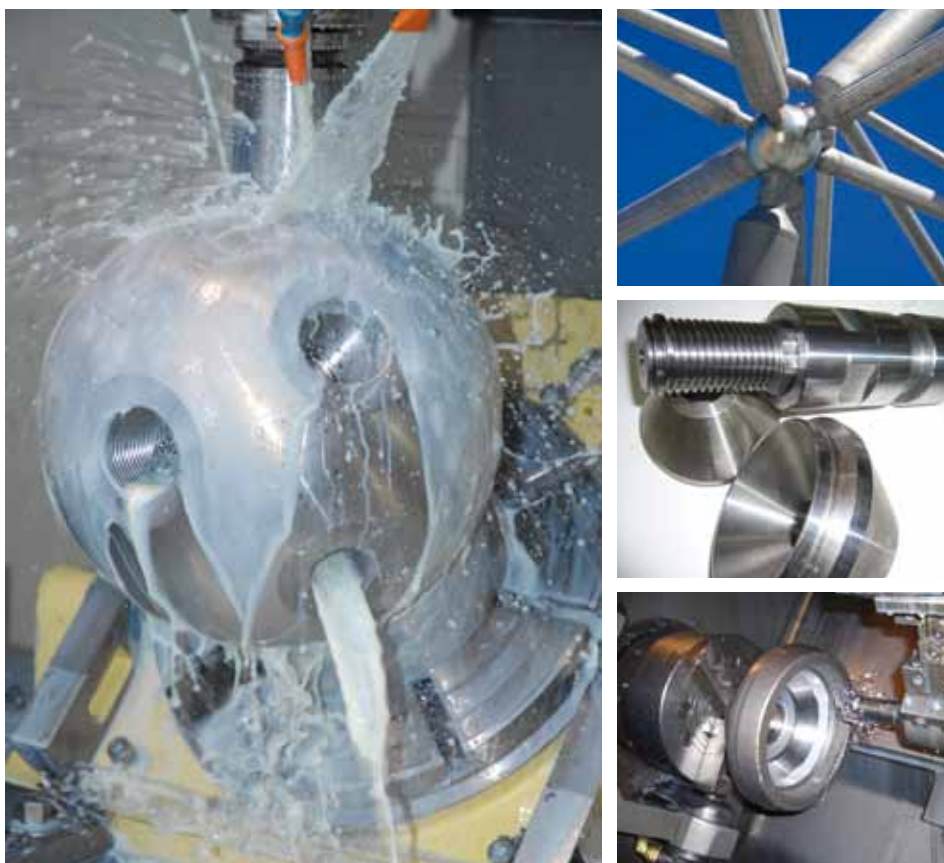
Fig. 26 - a) Nodo in opera viti e con viti e coni, b) Viti e coni c) e d) Lavorazione con macchine a controllo numerico del nodo sferico e del cono terminale delle aste
