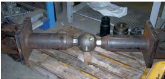
Fig. 28 - Apparecchiatura di prova per il test dinamico di penetrazione dell'acqua sul cuscino ETFE
