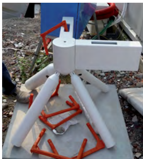
Fig. 11 - Nodo tipico di estradosso
