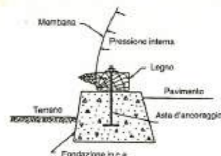
Fig. 7.27 Esempio di struttura pneumatica ancorata a trave di bordo in cemento armato.
