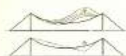
Fig. 2.9 La fune libera: elemento a geometria variabile sotto carico; a) variazione della configurazione dovuta a carichi distribuiti (p.e. La depressione esercitata dal vento); b) variazione della configurazione per carichi concentrati.
