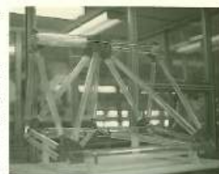
Fig. 8.84 Modello in plexiglass di controllo geometrico e della sequenza di montaggio dei componenti elementari
