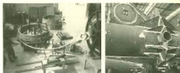
Fig. 8.76 Formazione di una fune portante con capicorda di tipo open bridge socket.
