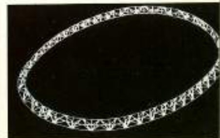
Fig. 8.70 Elementi costruttivi principali del sistema di copertura: Anello reticolare, sistema tensostrutturale, sistema di copertura in P.T.F.E. (Teflon)
