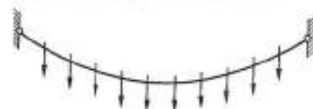
Fig. 5.6 Fune soggetta a carichi verticali.
