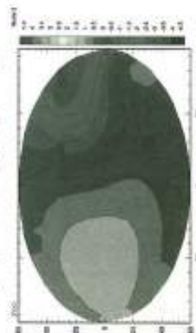
Fig. 4.9 bis Diagramma delle pressioni medie per l'analisi secondo il metodo della decomposizione ortogonale.
